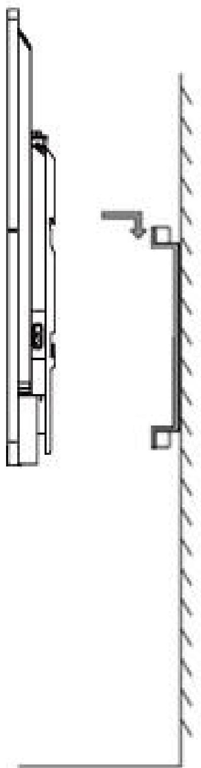
Задняя панель должна быть установлена на соответствующие фиксаторы
