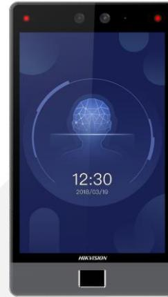
Терминал доступа DS-K1T680DFW является терминалом доступа с функцией распознавания лиц. В основном применяется в системах контроля доступа на территории логистических центров, аэропортов, образовательных учреждений, жилых помещений, на станциях сигнализации и т. д.
